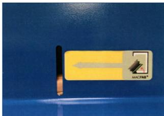
Lorsque le bélier s'arrête au niveau de la fente de « balle complète » au cours de la course de compactage, la hauteur maximale de la balle est atteinte.
