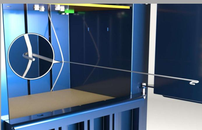
9. Tirez le feillard avec le crochet fourni avec la presse.
