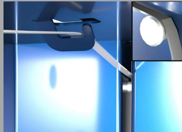
2. Passez le feillard par le crochet et derrière le support sur le panneau arrière.
