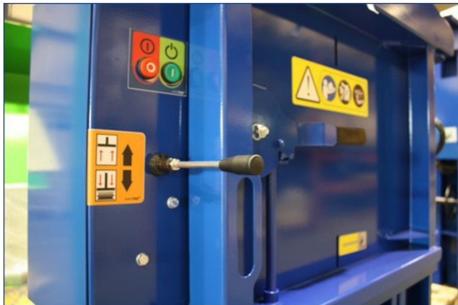
Dévissez le levier et le revisser dans la position horizontale. Serrez le contre-écrou pour le fixer solidement.
